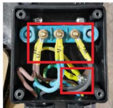
Rajah 1 : Sambungan kotak terminal
